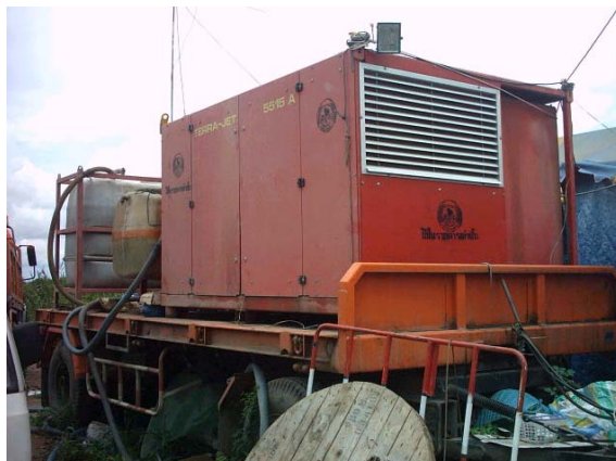
รูปที่ 4.14 Power Unit
